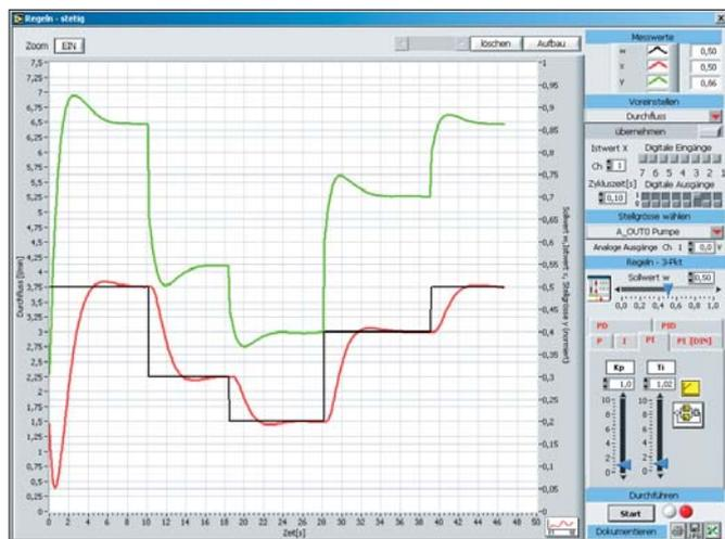
Apprendre pas à pas, avec FluidLab®-PA, les bases de la régulation. L'interface EasyPort établit le lien entre le PC et le matériel, à savoir les modules EduKit PA, la station de travail MPS® PA Compact ou les stations MPS® PA de filtration, de mélange, de remplissage et réacteur.
